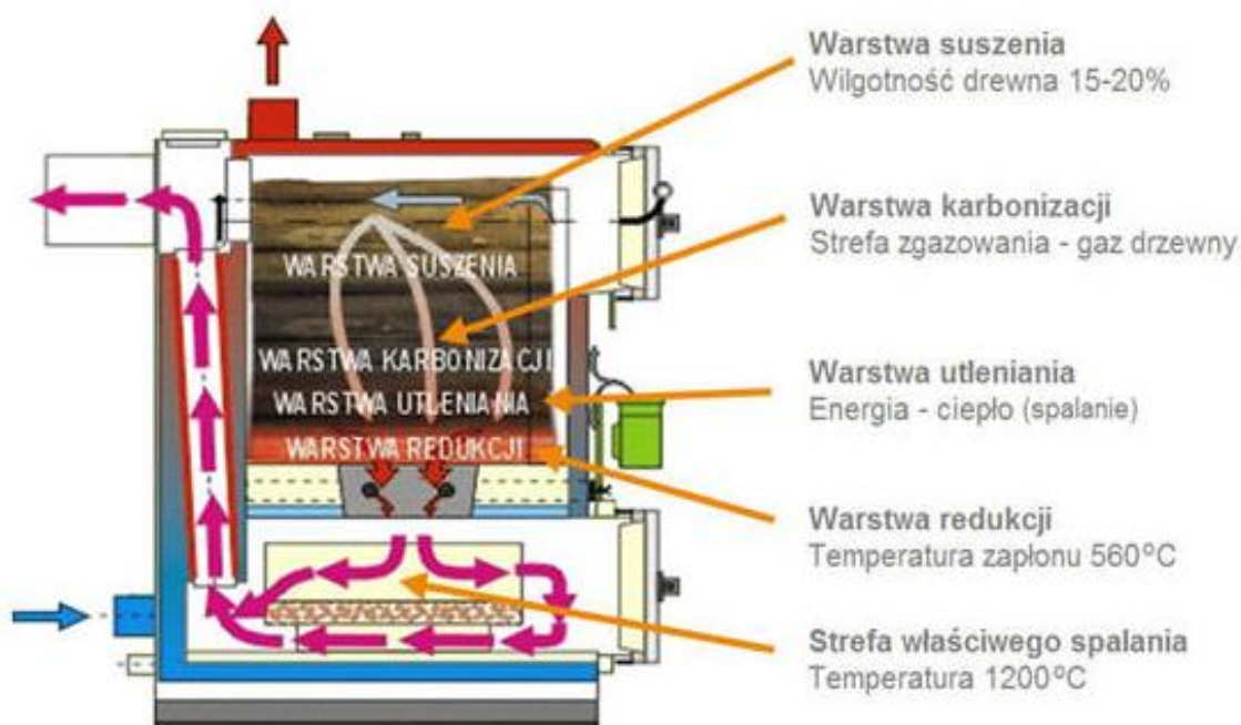
Ryc. 15. Schemat spalania drewna w kotle zgazowującym
