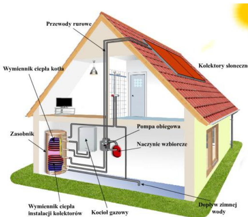
Ryc. 10. Schemat instalacji kolektorów słonecznych w domu jednorodzinnym
